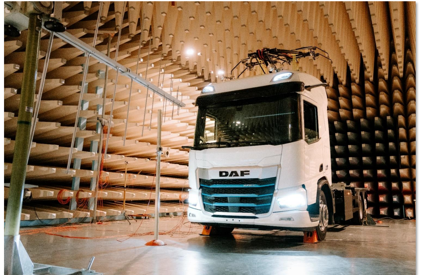
EMV Testing im Prüflabor
